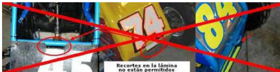
Figura A2: Enganches frontales NO aceptables
