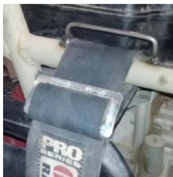
Figura B-28: Arnés del conductor, sistema de sujeción lateral del arnés de hombro
